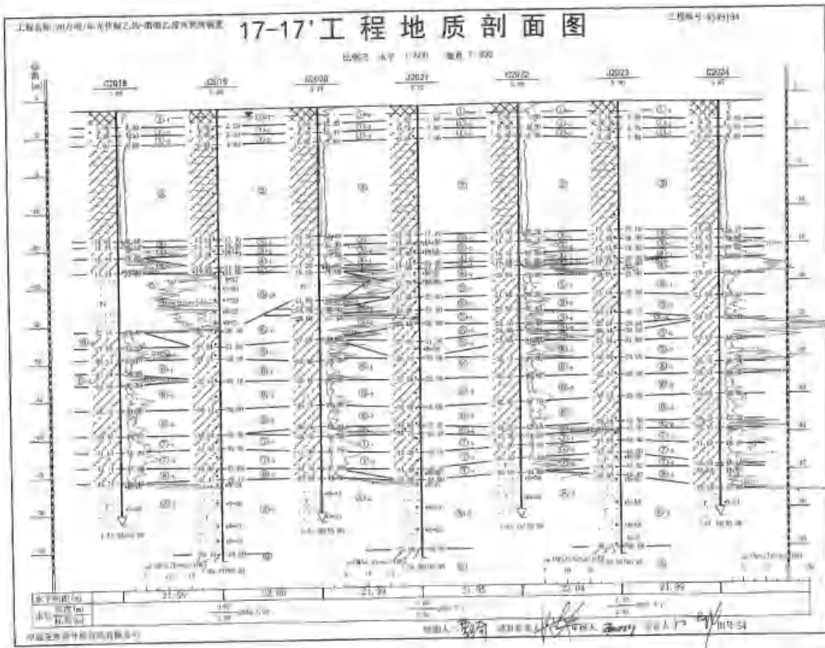
图 5.2.5-14 典型工程地质剖面图
