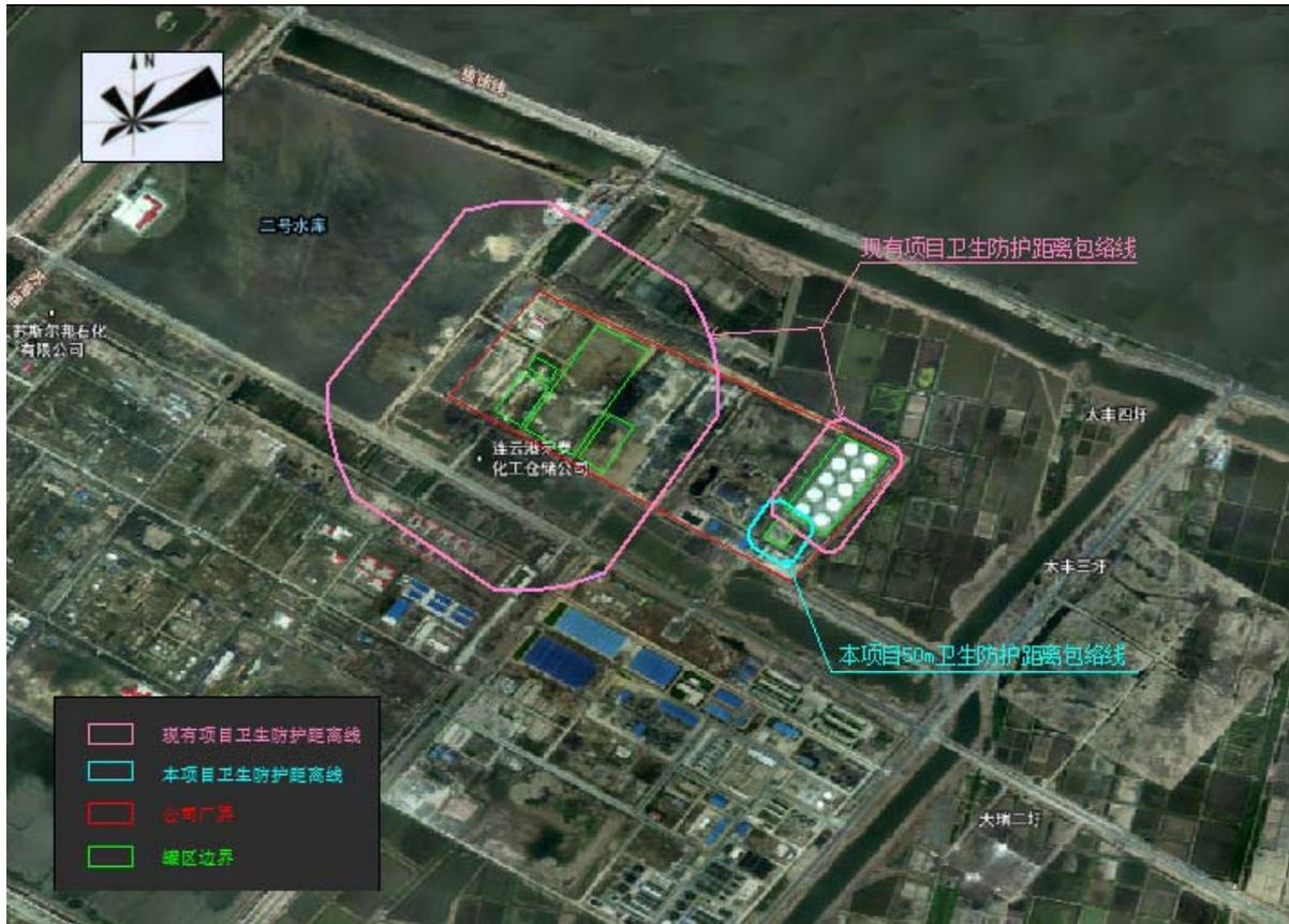
图 6.1.5 卫生防护距离包络线图
